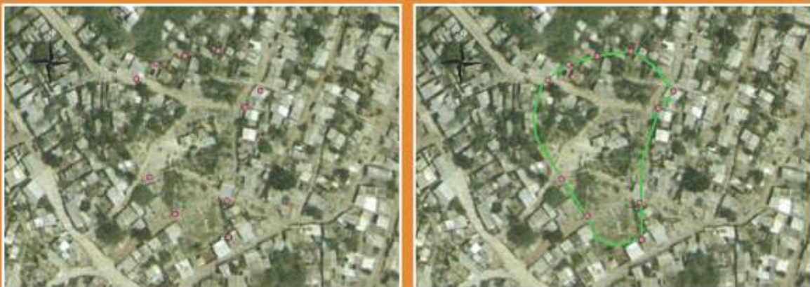
Figuras 15 y 16. En la imagen de la izquierda se muestran los puntos del escarpe (en color rosado) que se pudieron levantar con GPS. En la imagen de la derecha se ha definido la zona de movimiento de ladera (línea de color verde) usando los puntos de gps y con las curvas de nivel.
