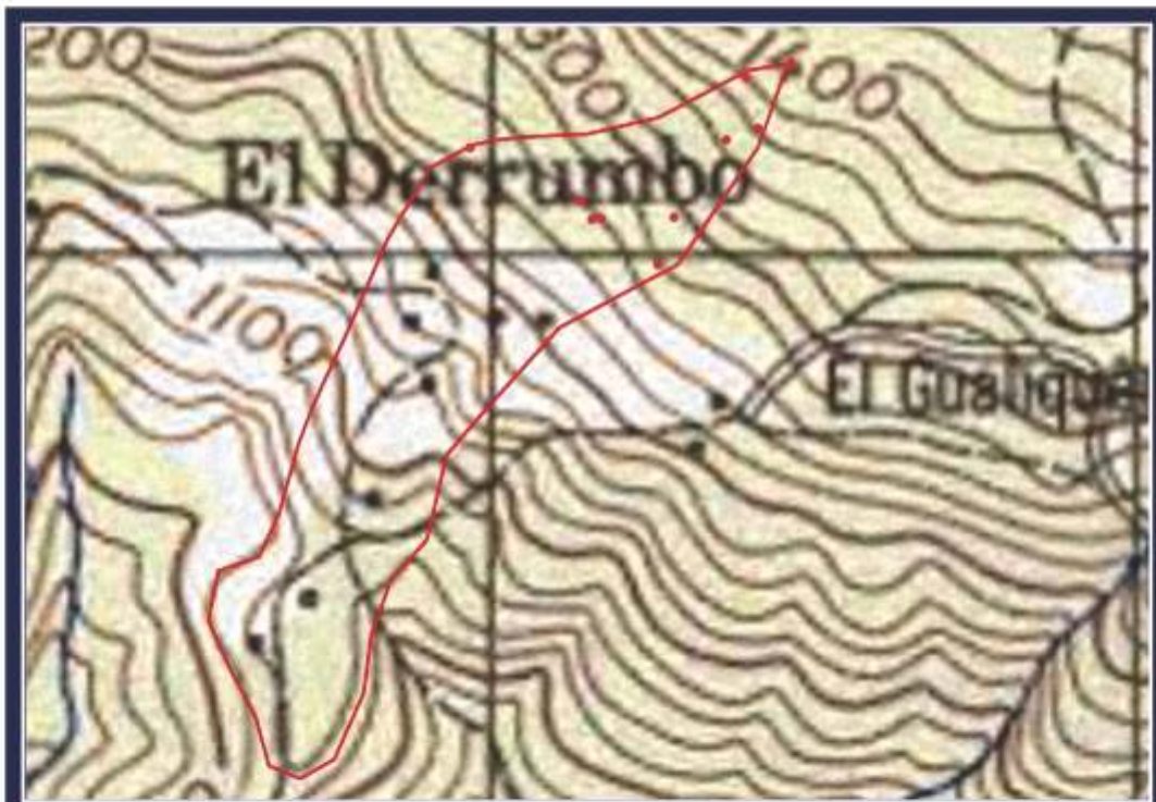
Figura 3. Se aprecia que existe un cambio en las curvas de cóncavas a convexas. La propia toponimia del lugar (el nombre del derrumbo) es un buen indicador.
