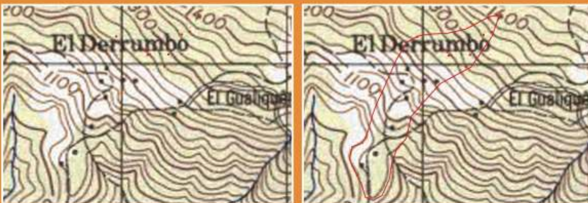
Figuras 17 y 18. En la imagen de la izquierda se muestran algunos puntos de un escarpe (en color rojo) que se identificaron. Usando las curvas de nivel para interpretar la geomorfología a partir de estos puntos se pudo definir la zona de movimiento de ladera (línea de color rojo).
