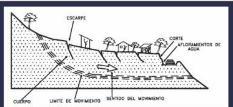
Figura 20. Escarpes, grietas de tensión en viviendas.
